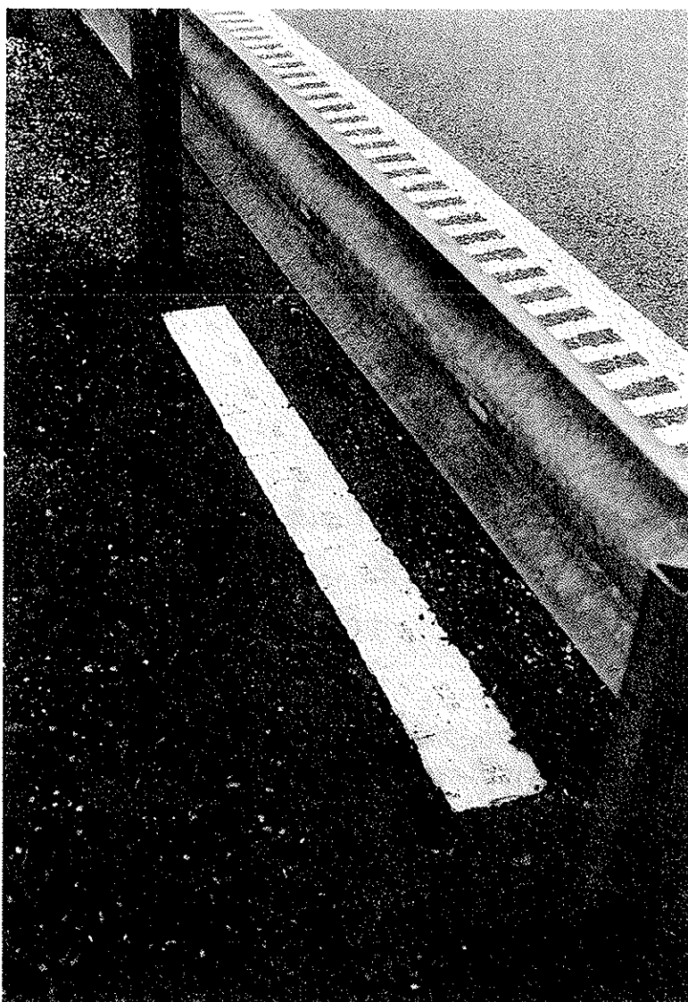
FIGUR 23 På fältprovplatsen vid riksväg 40 placerades provkropparna i speciella riggar nedsänkta i vägrenen.
